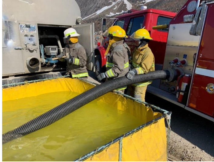
Photo ci-dessus : Un instructeur du service d'incendie fait la démonstration de techniques d'aspiration visant à approvisionner efficacement le camion de pompier en eau.
